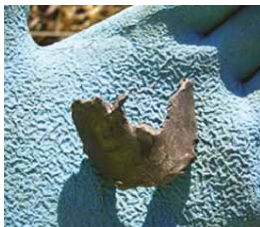
Rysunek 18. Przykład spalonego fragmentu metalu znalezionego 100 metrów przed uderzeniem samolotu w ziemię. (Załącznik XI).
