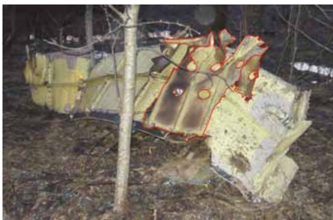
Pierwszy dźwigar lewego skrzydła z wyraźnie widocznymi osmoleniami i opaleniami na skutek wybuchu
