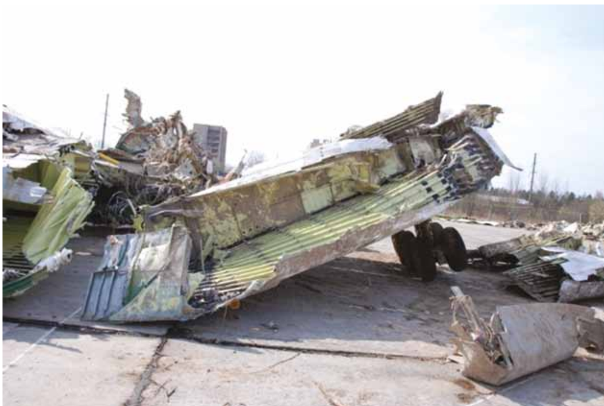
Lewe skrzydło, z którego wybuch wyrwał pierwszy dźwigar i część drugiego oraz trzeciego
