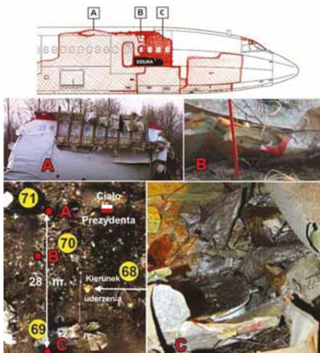
Rysunek 31. Lokalizacja części z kabiny prezydenckiej na głównym miejscu wypadku w odległości 28 m w poprzek kierunku uderzenia (punkty A i C). Widoczne oznaki działania wysokiej temperatury i wysokiego ciśnienia w środku części prezydenckiej (część C).
