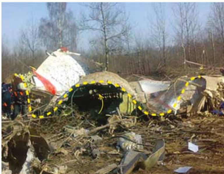
Rysunek 14. Część kadłuba odwrócona i otwarta (żółta linia i strzałka). Załącznik VIII.
